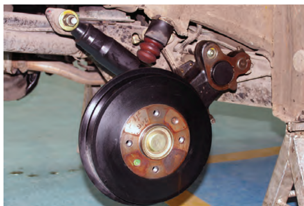
شکل ۱۷۷-۳- نصب کمک فنر
