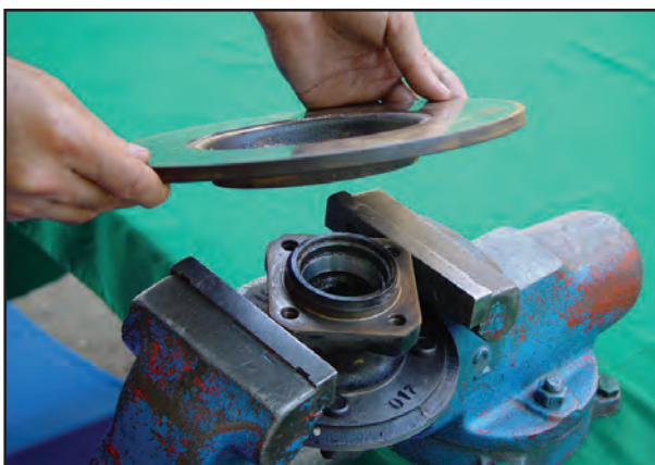
شکل ۱۲۶-۱ بازکردن دیسک ترمز
