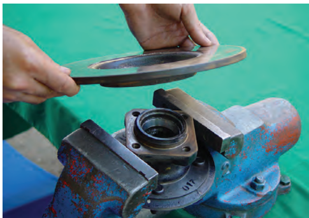
شکل ۳-۹۸- جدا کردن دیسک ترمز از تویی چرخ
