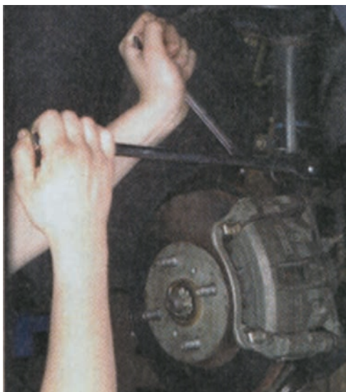
شکل ۳-۱۰۰ نصب مجموعه سیستم تعلیق روی خودرو
