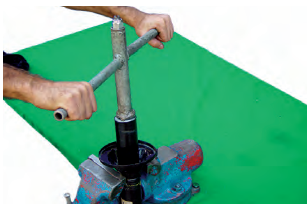
شکل ۳-۹۱ – باز کردن مهره نگه‌دارنده کمک فنر
