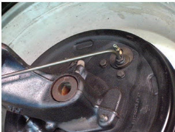
شکل ۱۰۳-۱- پاک کردن اطراف اتصالات
