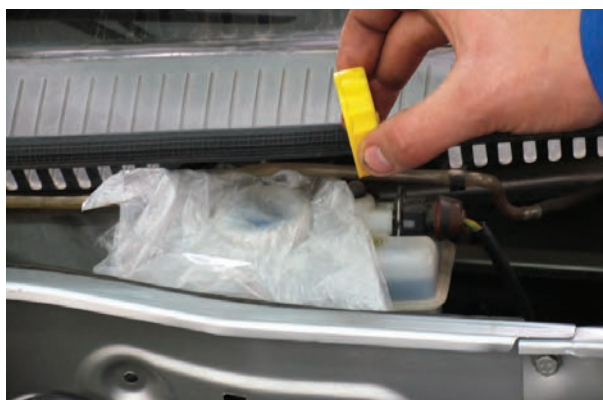
شکل ۱۳۸-۱- مسدود کردن در مخزن مایع ترمز
