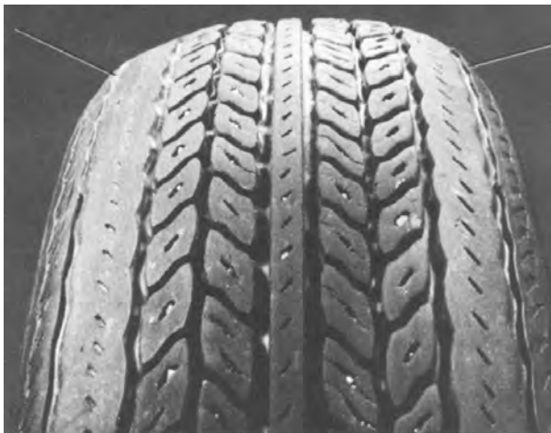
شکل ۳-۲۱۴- سایش در اثر رانندگی غلط (پیچیدن تند)
