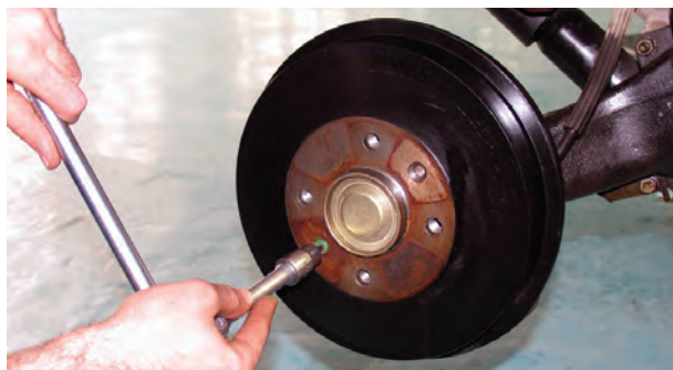
شکل ۱-۸۹ – باز کردن پیچ کاسه چرخ
