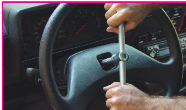
شکل ۲-۳۳- پیاده کردن فلکه فرمان
