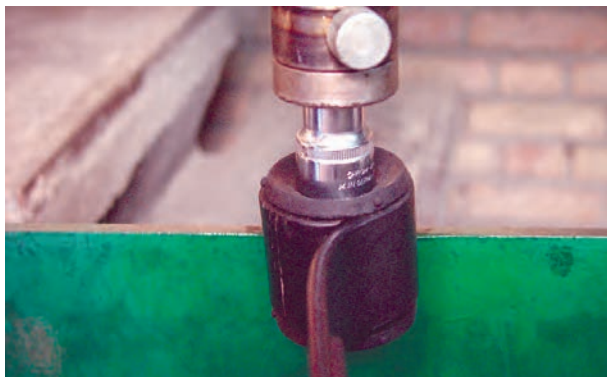
شکل ۳-۶۹- بوش لاستیکی فلزی محل اتصال شاه فنر
