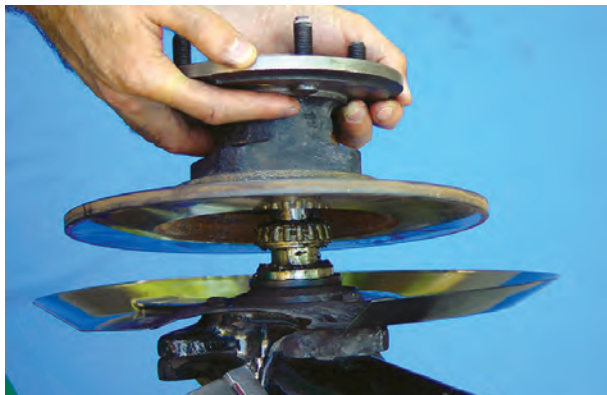
شکل ۳-۹۴- خارج کردن دیسک ترمز و تویی از روی محور چرخ
