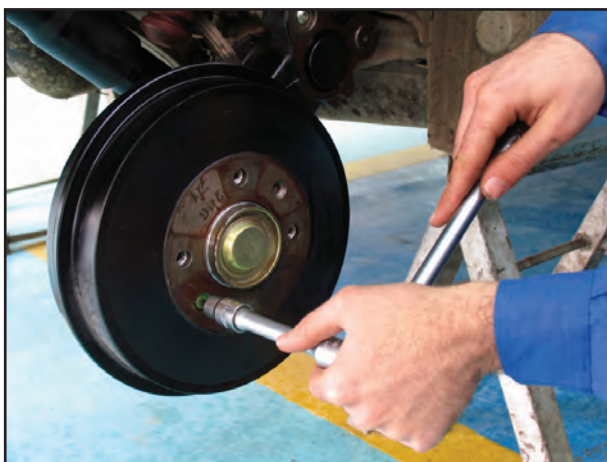
شکل ۱-۱۰۲ – بستن پیچ نگه‌دارنده کاسه چرخ
