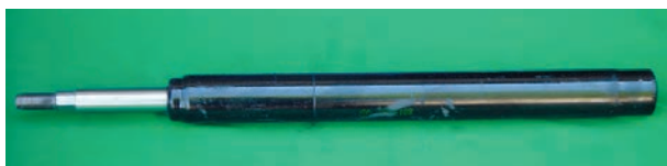
شکل ۳-۹۲ – کمک فنر قابل تعویض
