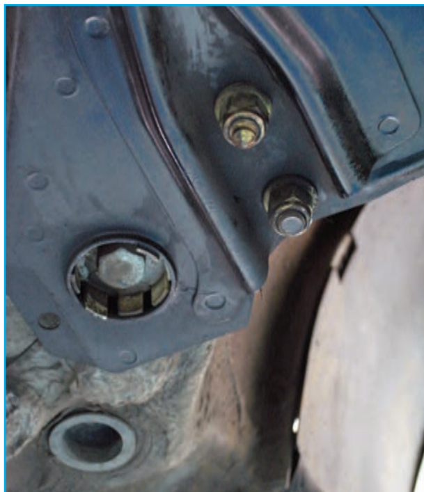
شکل ۳-۱۳۰ پیاده کردن میل موج گیر بلند
