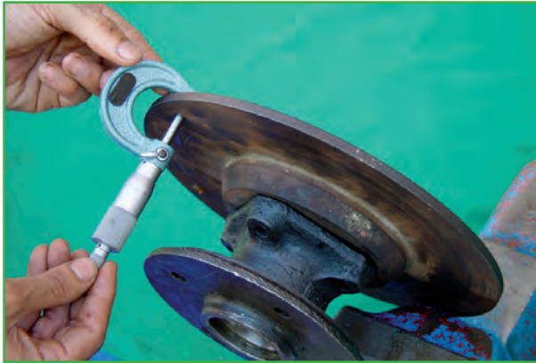
شکل ۱۲۴-۱ اندازه‌گیری ضخامت دیسک
