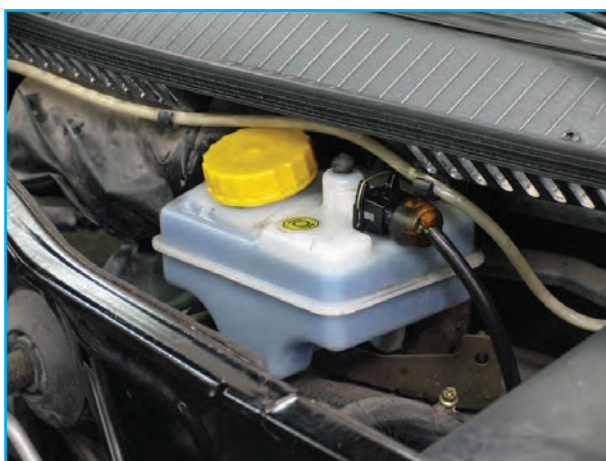
شکل ۱۲۸-۱- اتصال حسگر اخطار دهنده کم بودن مایع ترمز در مخزن
