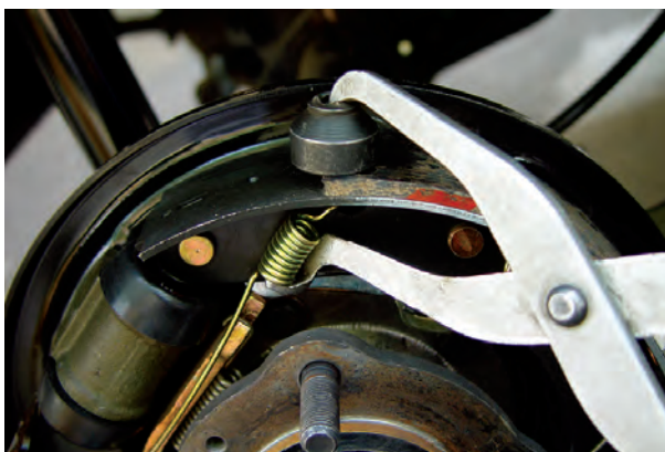
شکل ۱-۱۰۷- جا زدن فنر بالایی کفشک
