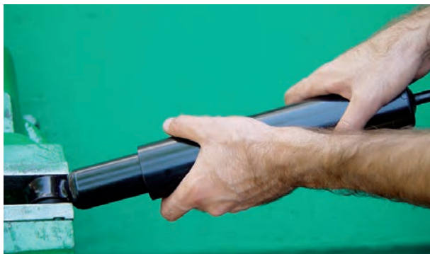
شکل ۳-۷۴- آزمایش کمک فنر
