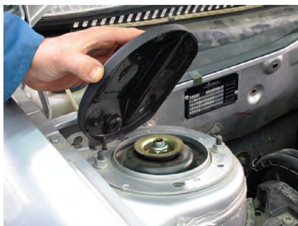
شکل ۳-۱-۳- برداشتن پوشش بالایی تکیه‌گاه کمک فنر
