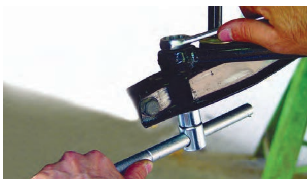
شکل ۳-۸۱- باز کردن میل تعادل از طبق
