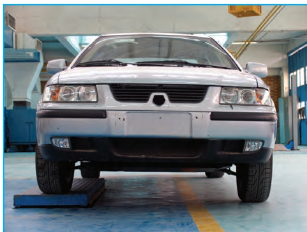
شکل ۱۹-۳ مزایای سیستم تعلیق مستقل
