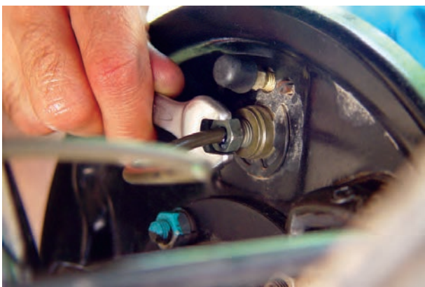
شکل ۱۰۵-۱- باز کردن مهره اتصال لوله ترمز
