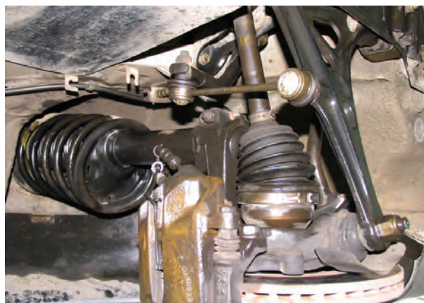
شکل ۳-۱۳۱ نصب میل موج گیر کوتاه
