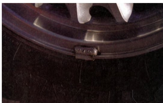
شکل ۳-۲۳۱- نصب وزنه روی رینگ
