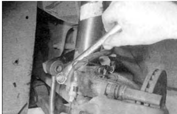
شکل ۱۱۸-۳- بستن پیچ نگه‌دارنده کمک فنر
