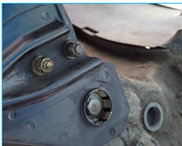
شکل ۳-۱۲۲- باز کردن پیچ های طبق
