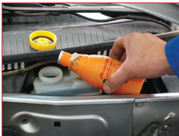
شکل ۱-۶۸- پر کردن مخزن مایع ترمز تا حداکثر (MAX)
